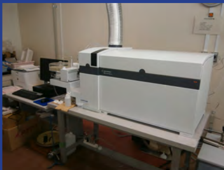
ICP-MS (Agilent 8800 シリーズトリ プル四重極) (4F 測定室 1)
