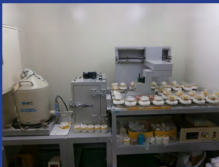
サンプルチェンジャ付ゲルマニウム 半導体検出器 (U-8 容器用) (4F 分析機器室 1)
