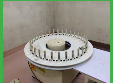
簡易型 ^{137}\text{Cs} ガンマ線照射装置
