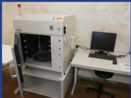
エックス線照射装置 (メディエック スタック MX-160Labo) (BF 照射装置室)
