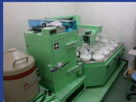
サンプルチェンジャ付ゲルマニウム 半導体検出器 (マリネリ容器測定可) (4F 分析機器室 2)
