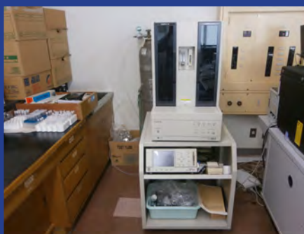
2πガスフローカウンタ (ALOKA LBC-4211B) (4F 測定室 1)
