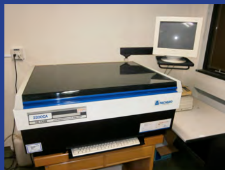
液体シンチレーションカウンタ (2200CA) (4F 測定室2)
