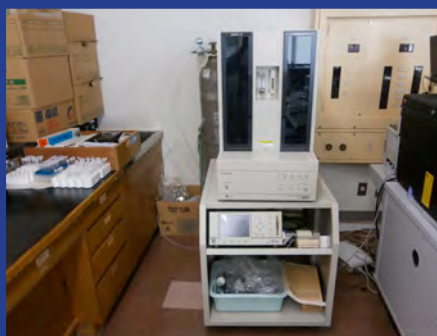
2 \pi ガスフローカウンタ (ALOKA LBC-4211B) (4F 測定室1)
