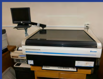
液体シンチレーションカウンタ (2700TR/SL) (4F 測定室2)
