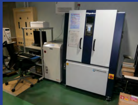
粉末エックス線回折析装置 (Rigaku Ultima IV) (2F 共用実験室6)
