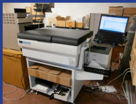
液体シンチレーションカウンタ (Tri-Carb 2910TR) (4F 測定室1)
