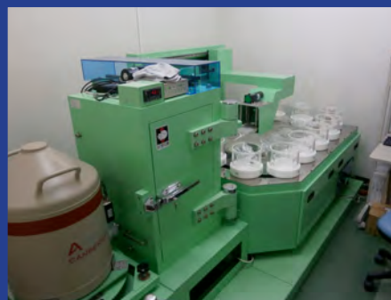
サンプルチェンジャ付ゲルマニウム 半導体検出器(マリネリ容器測定可) (4F 分析機器室2)
