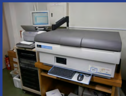
液体シンチレーションカウンタ (Tri-Carb 31000TR) (4F 測定室2)
