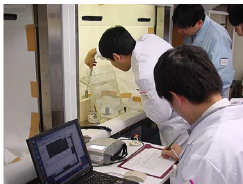
写真5 P-32線源からの \beta 線による制動放射実験
