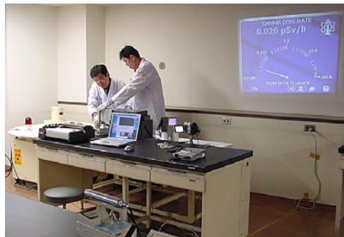
写真4 Cs-137線源からの \gamma 線の多重層遮蔽実験
