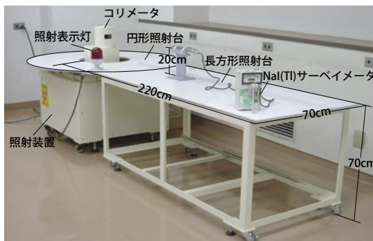
写真1 簡易型 137 Csガンマ線照射装置
